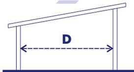
La distancia entre apoyos (**D**) determina el espesor del panel según su autoportancia.
